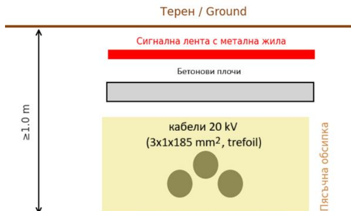
Фигура 2.4-1 – Напречен профил на изкопа за подземния кабел 20 kV.
