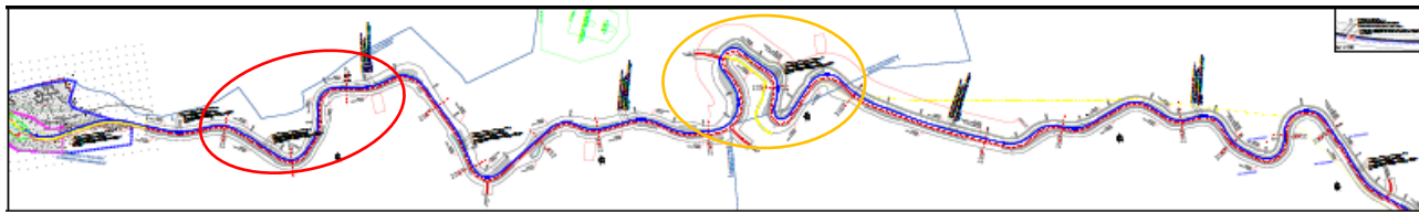
Фигура 2.2-8 – Кабелно трасе по Вариант 1 с детайли: а) изкоп (червен контур) и насип (жълт контур).
